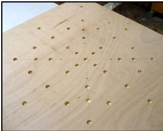
Abb.16: Bohrung der Löcher für die Magnete, nach vordefiniertem Muster (siehe Abb.14)
