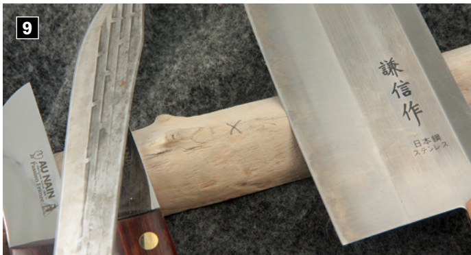
9 Die Auflagepunkte der Messer werden mit einem Bleistift auf der Vorderseite angezeichnet und...
