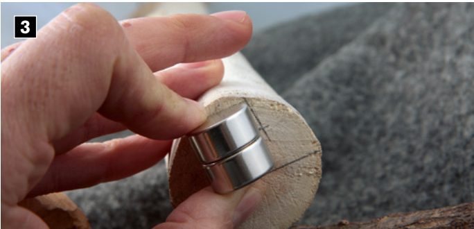
3 Die Leiste soll flächig an der Wand aufliegen und muss daher von einer Seite plan gehobelt werden. Die Tiefe muss bei diesem Projekt für zwei Magnete ausreichen.
