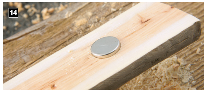
14 Setzen Sie die Magnete immer wieder probeweise ein und testen Sie dabei auch die magnetische Haltekraft, die auf der anderen Seite des Holzes entsteht.
