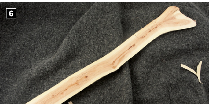
6 Das Hobeln auf der Hobelmaschine hinterlässt eine plane und fein geglättete Fläche. Von der aus werden später die Magnete eingesetzt.
