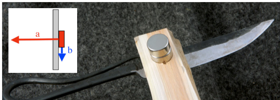
Haltekraft: In Magnetisierungsrichtung (in der Grafik von supermagnete.de mit „a“ gekennzeichnet) ist die Haltekraft viel höher als in Scherrichtung „b“. An Vergleichsstücken sollte man die notwendige Haltekraft testen.
