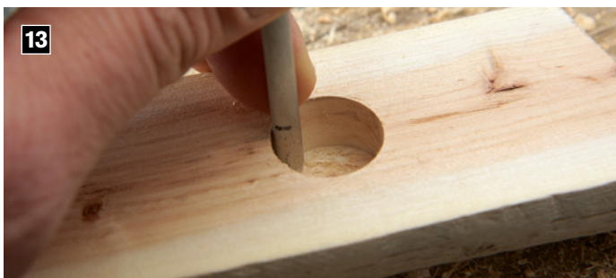
13 Die Bohrung muss tief genug für zwei Magnete werden. Zwischen der Außenseite und den Magneten darf die Holzschicht nicht dicker als rund drei Millimeter sein.
