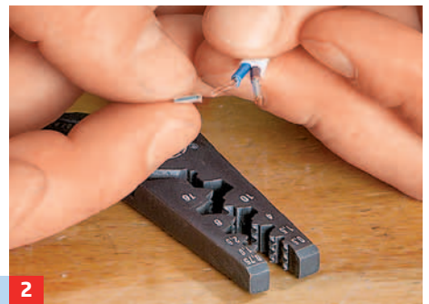
2 Die Kabel-Enden abisolieren und Aderendhülsen aufquetschen.
