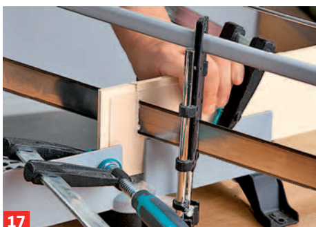
17 Es folgt der Zuschnitt der satinierten, 3 mm starken Acrylglasplatte. Die Anschlüsse an Vorder- und Rückwand ...
