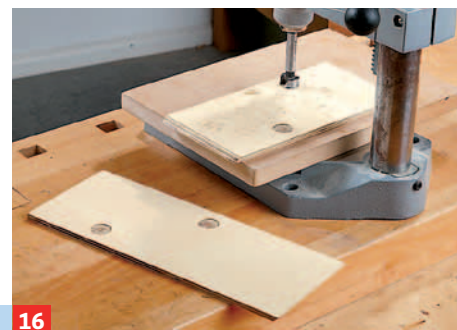
16 Auf Vorder- und Rückseite jeweils an den Außenflächen zwei diagonal versetzte ca. 2 mm tiefe Zapfensenkungen bohren.
