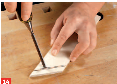
14 Je Seite sind hier zwei parallele Schnitte nötig. Das Restmaterial hebeln Sie mit einem schmalen Stechbeitel heraus ...
