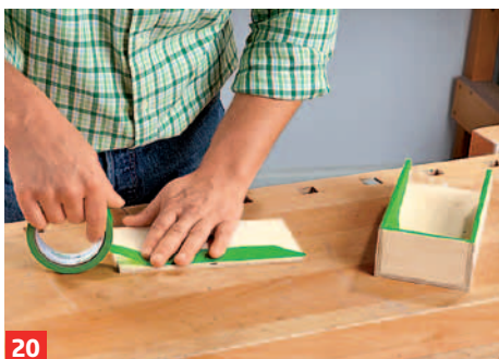
20 Auch hier alles sauber schleifen und die Kanten brechen. Vor dem Lackieren die Leimflächen (folgt später) abkleben.
