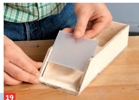
19 Das Leuchtgehäuse wie auf Seite 19, Bild 6 gezeigt (ohne Rückwand) verleimen. Acrylplatte zur Probe einschieben.
