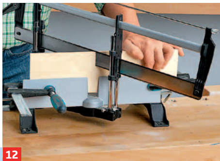
12 ... zuschneiden als auch Front und Rückwand. Hierzu müssen Sie die auf Breite geschnittenen Bauteile hochkant fixieren.
