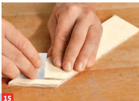
15 ... und versäubern die Nut dann mit einem Stück gefaltetem Schleifpapier.
