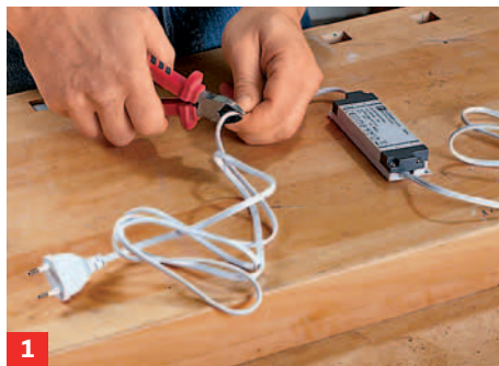
1 Zuleitung samt Netzstecker etwa 25 cm vor dem fertig konfektionierten Trafo mit dem Seitenschneider abschneiden.
