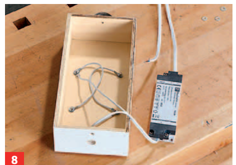
8 In der Box die Trafo-Ausgangsleitungen diagonal versetzt anschließen und zu je einem freien Magneten durchschlaufen.
