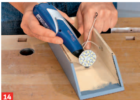
14 Mit reichlich Heißkleber fixieren Sie die Fassung samt LED-Leuchtmittel wie oben gezeigt im Leuchtkasten.
