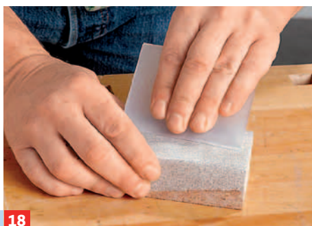
18 ... mit der Gehrungssäge exakt zuschneiden. Den Sägeschnitt dann beischleifen.
